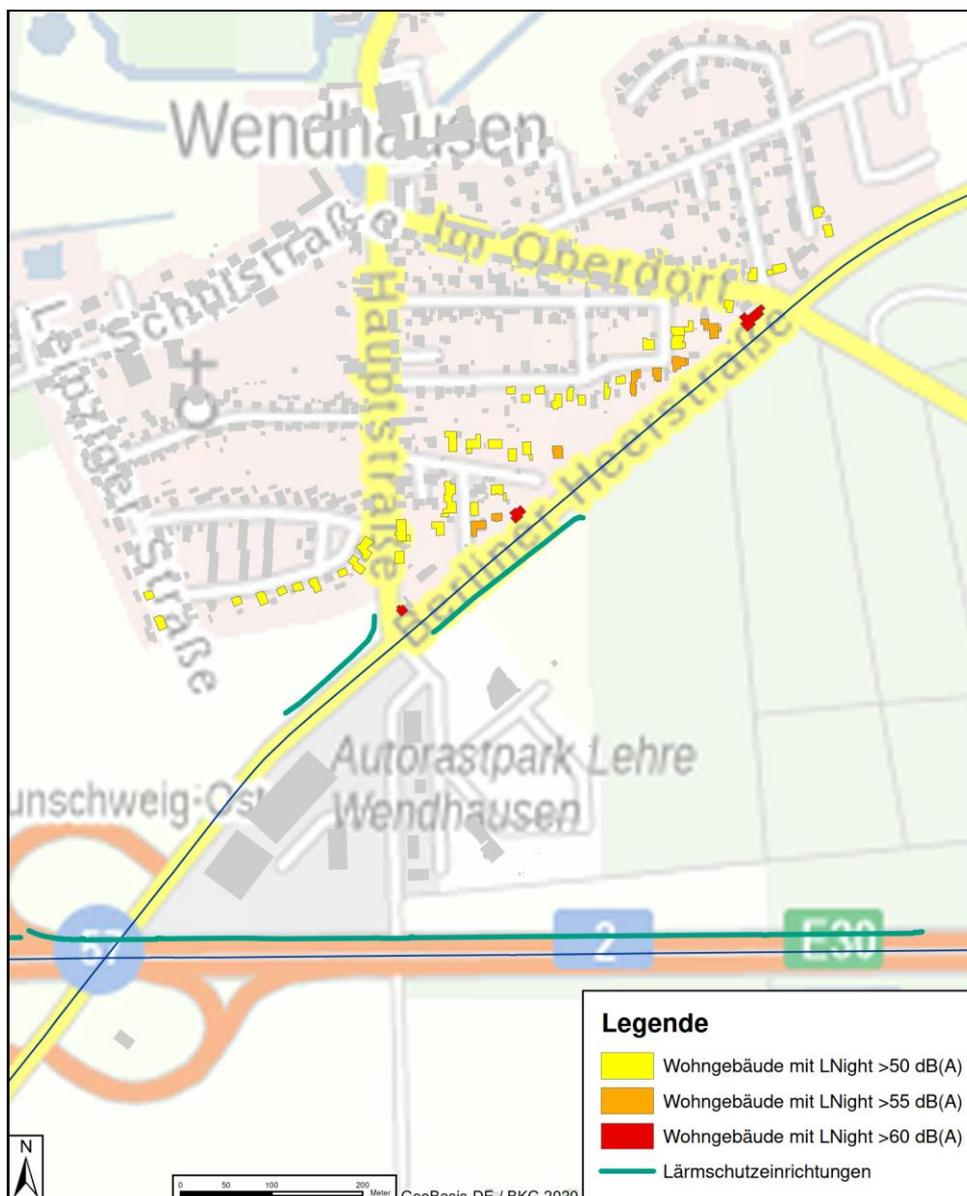
Trotz der vorhandenen Lärmschutzeinrichtungen südlich entlang der BAB A2 werden die autobahnnahen Wohngebäude mit bis zu 55 dB(A)  $L_{Night}$  nachts belastet (vgl. Abbildung 3).
